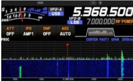
Free-DV hat einen neuen Modus: RADE V1. Bislang ist dies der natürlichste digitale Sprachmodus, den ich je gehört habe. Er nutzt nur 1,5 kHz Bandbreite, kann aber 8 kHz breites Audio erzeugen! Das ist unglaublich! RADE steht für Radio-Autoencoder-Technologie und ist ein neuer Ansatz für die digitale Übertragung von Sprache über Kurzwelle. RADE V1 kombiniert maschinelles Lernen (ML) mit klassischem DSP, um Sprache in hoher Qualität über HF-Funk bei einem SNR von nur -2 dB zu übertragen.
